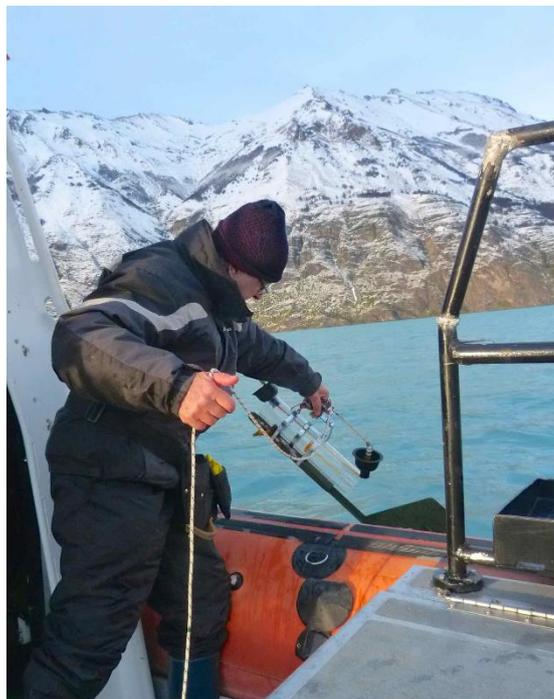
Figura 8. Perfil térmico y de oxígeno disuelto en la estación Brazo Sur del Lago Argentino. Imagen de la derecha: utilización de la botella de Van Dorn para realización de perfil vertical en Brazo Sur.
